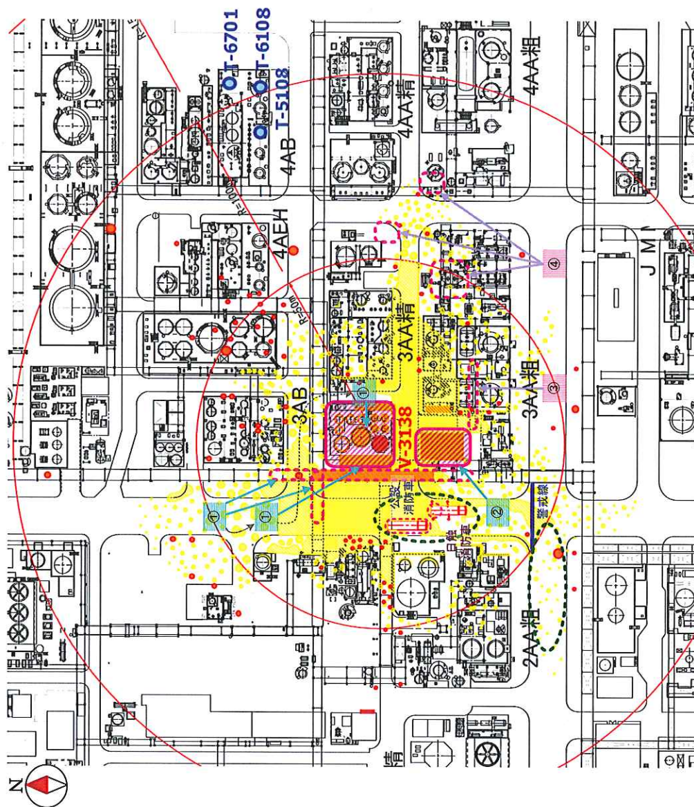
(図 4-19) タンク周辺火災エリア
