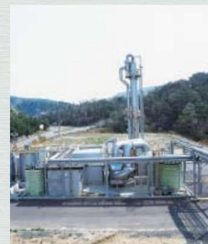
※触媒湿式酸化処理装置
