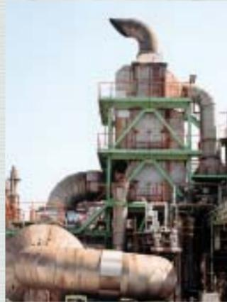
ベンゼンの触媒燃焼処理装置
